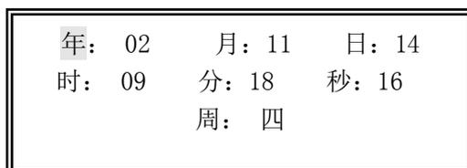
两秒钟后,“正在存储!”字样消失。表计自动将数据同时间(年、月、日、时、分)一起存储起来(秒的存储没有意义),掉电不丢失。
